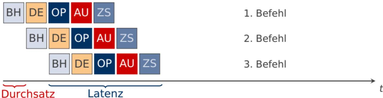
Pro Taktzyklus wird ein Maschinenbefehl abgeschlossen.
